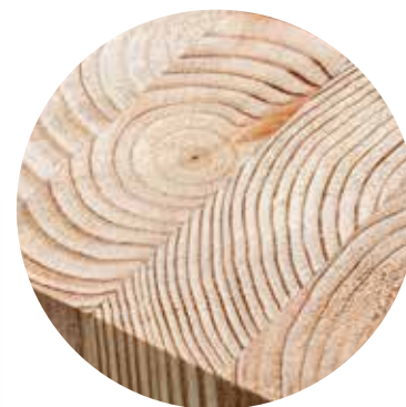
DÉTAIL DES PLANS DE COLLAGE BLC SAPIN/ÉPICÉA
