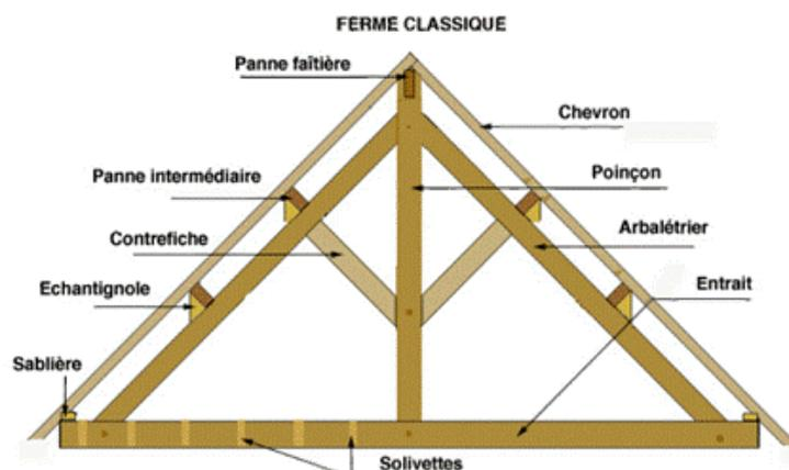
**Description de l'usage** Les charpentes traditionnelles sont destinées à assurer le transfert de charges en provenance de la toiture plusieurs types de bâtiments : logements, bureaux, petits commerces. Les longueurs et sections des bois collés largement utilisés les rendent particulièrement adaptés aux ouvrages de portées courantes.
